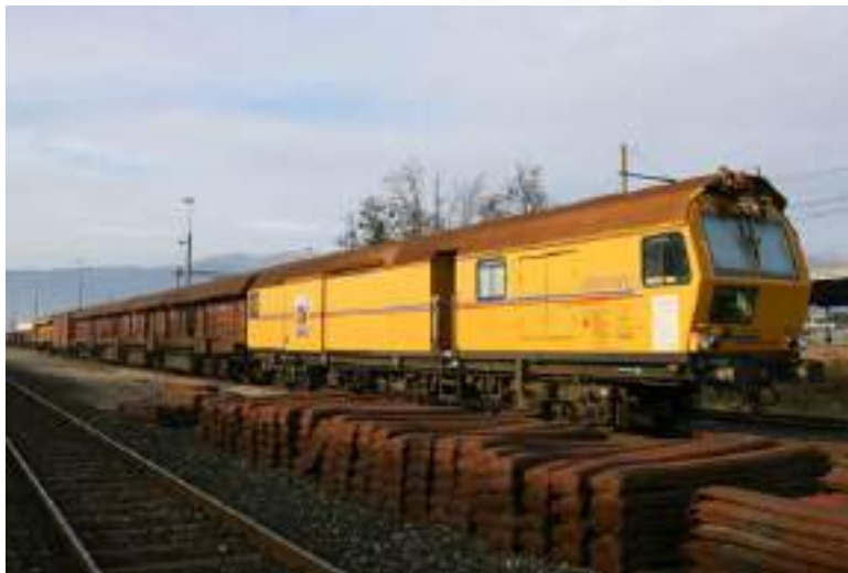
Train meuleur de rails (Scheuchzer S.A.)
