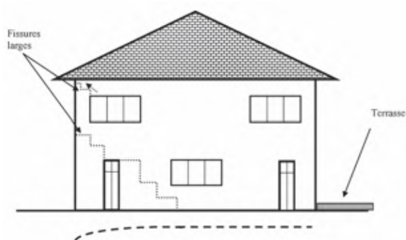
Figure 3 Mode de déformation provoqué par un retrait périphérique du sol sous la maison
