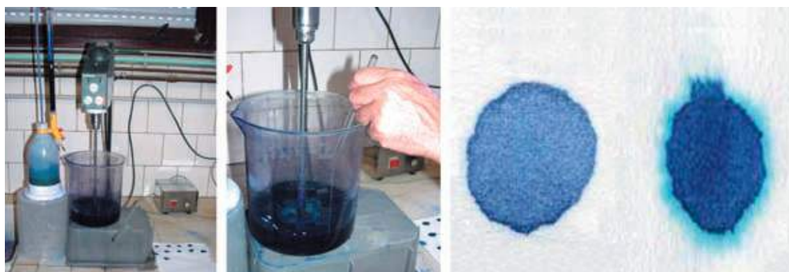
Matériel d'essai nécessaire (agitateur, béccher, pipette graduée)
